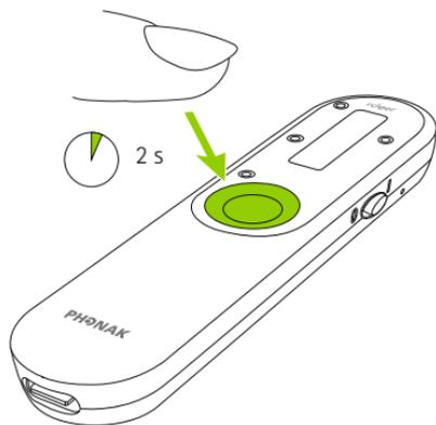
Die Stummschaltung des Mikrofons wird durch ein durchgestrichenes Mikrofonsymbol auf dem Display angezeigt. Um die Stummschaltung wieder aufzuheben, halten Sie die Funktionstaste erneut 2 Sekunden lang gedrückt.
