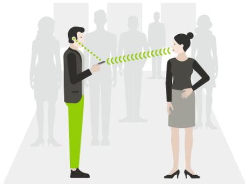
Das Mikrofon aktiviert automatisch einen schmalen Richtfokus und nimmt die Stimme der Person auf, auf die Sie zeigen. Dies wird durch ein Dreieck auf dem Display angezeigt.
